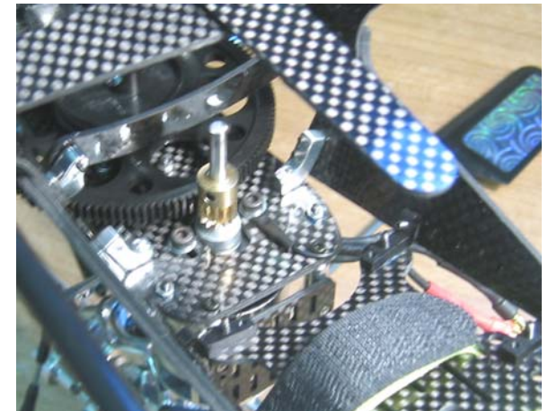
Kabelverlegung und Anschluß der Erdung am Motor
