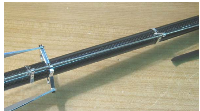
Einstellung der Gestängeführungen
