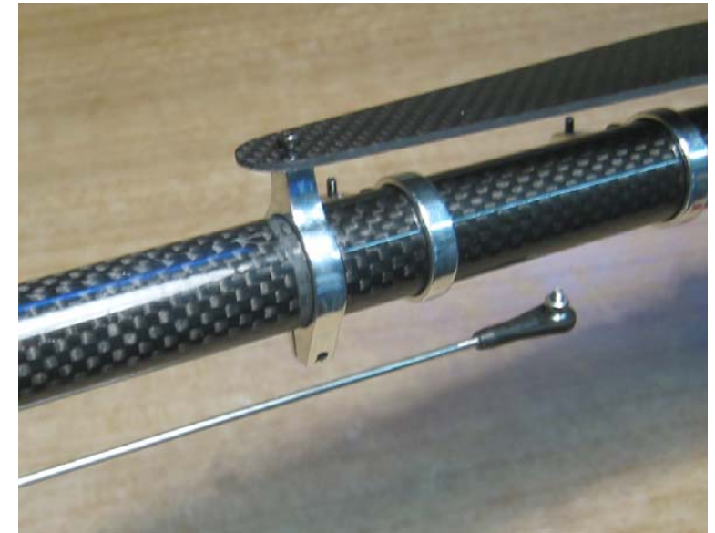
Angeschliffenes Heckrohr zur Kontaktierung der Erdung
