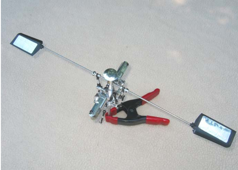
⇐ Vormontierter Rotorkopf incl. Paddereinheit
