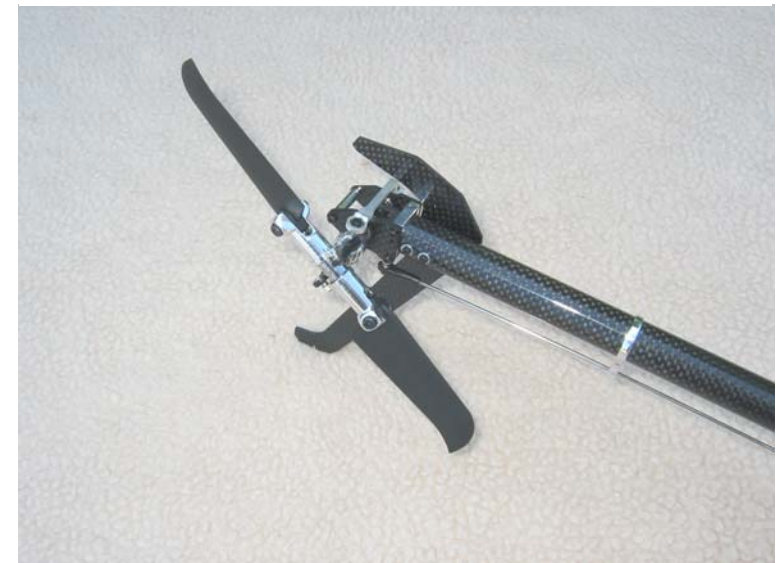
Heckrotor mit Blatthaltern und integrierten PMG's
