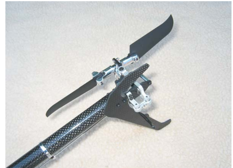
Heckrotor mit Blatthaltern und integrierten PMG's
