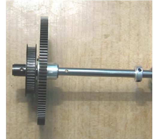
Riemenrad und HZR bei Rotorkopfmontage in hoher Lage
