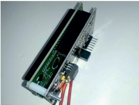
Schließen Sie den Temp.-Sensor wie abgebildet an. Sie können eine 3-adrige Leitung verwenden, um den Temp.-Sensor an beliebiger Stelle zu platzieren. Achten Sie unbedingt auf korrekte Polung ! ( Beschriftungsaufdruck muß nach außen weisen ! )
