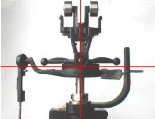
Jetzt dreh mal das Hauptzahnrad von Hand, einfach mal anschubsen, und beobachte die TS und das obere Ende der Welle. Da darf nichts eiern !!! Falls doch - Welle tauschen !
