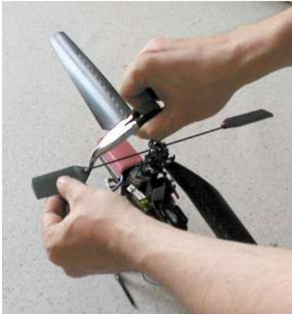
Sicherlich haben sich jetzt die Servos etwas verstellt- also, kurz mal Funke und Heli anschalten. So, jetzt peile mal von Vorne über die Paddels - sind die waagrecht zum Kopf ?
